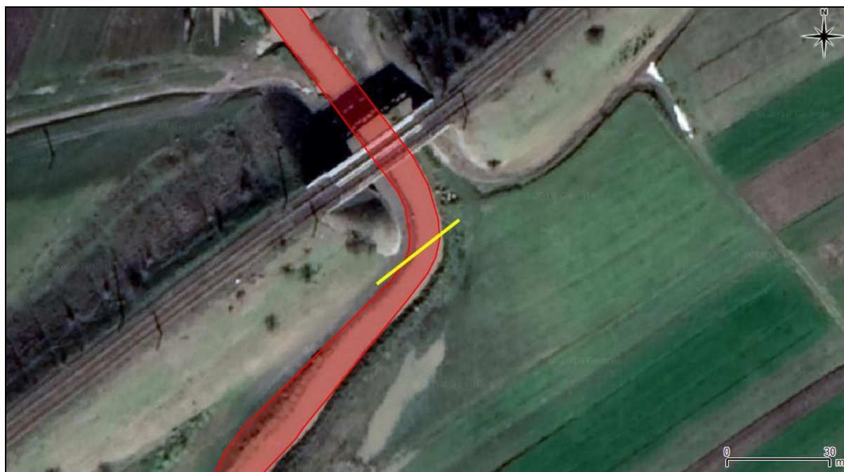
Figura nr. 15 – Tronsonul conductei de aducțiune în zona vizată de subtraversarea orizontală a pârâului Bratcov (linie galbenă), în perimetrul ROSCI0386 Râul Vedea (marcat cu roșu)
