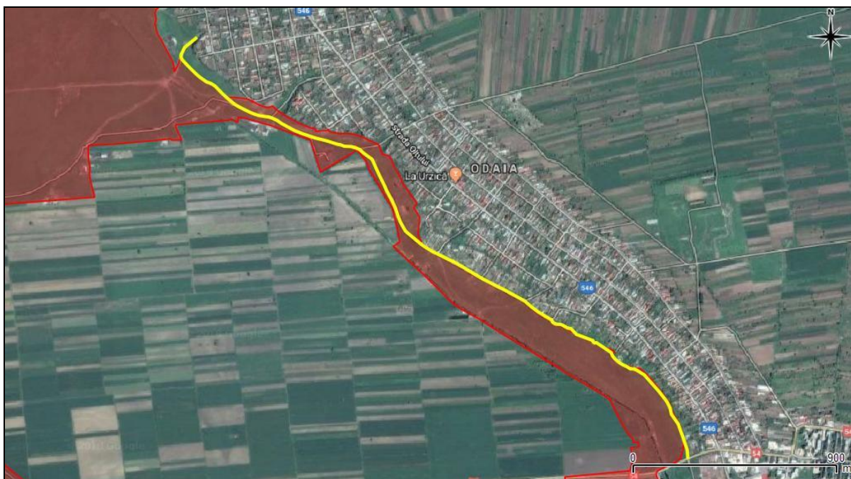
Figura nr. 30 – Localizarea tronsonului de pozare conducte de canalizare și de distribuție apă potabilă în vecinătatea vestică a zonei construite a municipiului Turnu Măgurele (culoare galbenă), tronson situat în perimetrul ROSCI0376 Râul Olt între Mărunței și Turnu Măgurele (marcat cu roșu)
