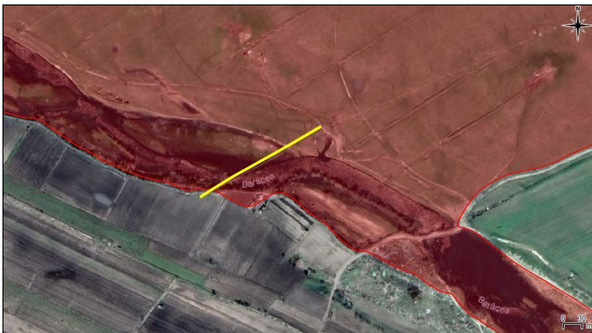
Figura nr. 19 – Aspect privind tronsonul vizat de schimbare conductă de legătură între puțurile 34 și 33 în perimetrul sitului de importanță comunitară ROSCI0386 Râul Vedea
