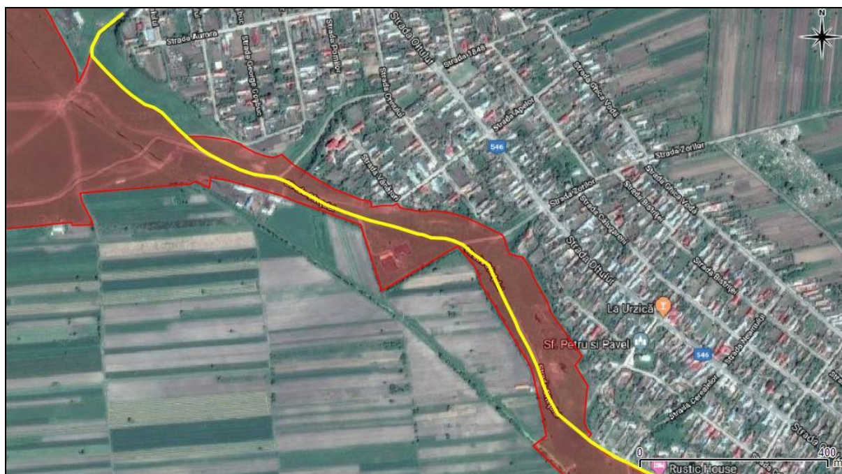
Figura nr. 38 – Aspect privind relația traseului de pozare a conductei de canalizare și de distribuție apă potabilă pe sectorul nordic al străzii Oltețului cu perimetrul sitului Natura 2000 ROSCI0376 Râul Olt între Mărunței și Turnu Măgurele
