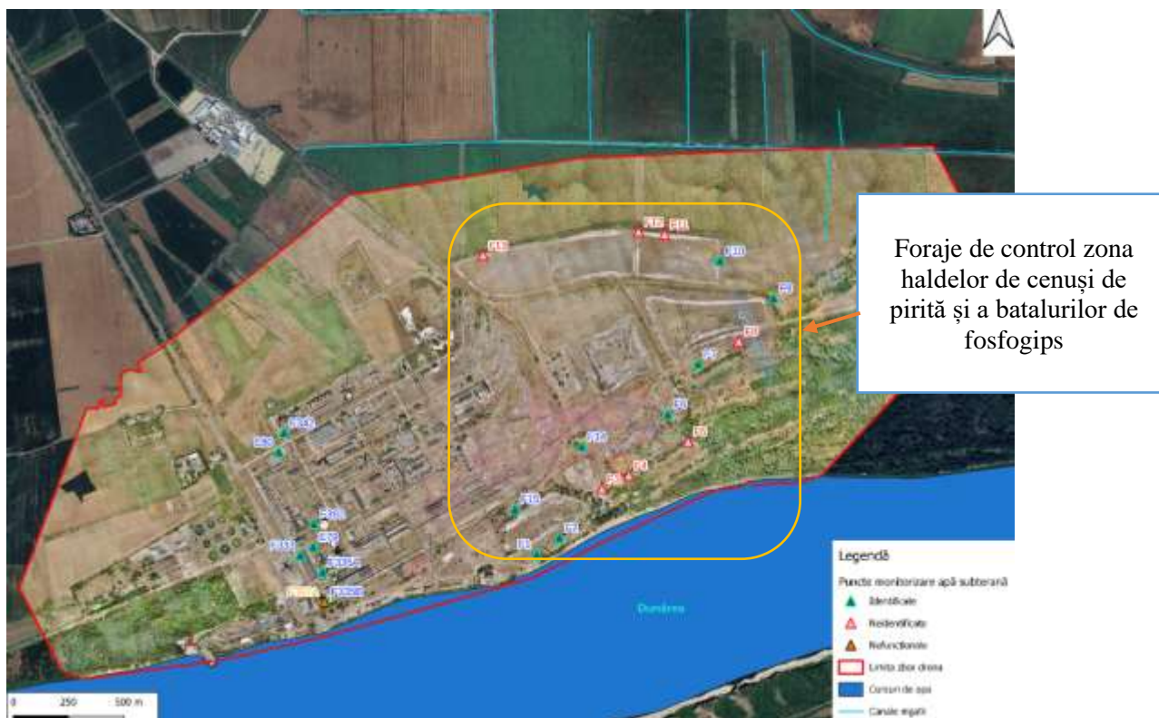
Figura nr.40. – Amplasare puncte monitorizare apă subterană pe, amplasament Donau Chem SRL
